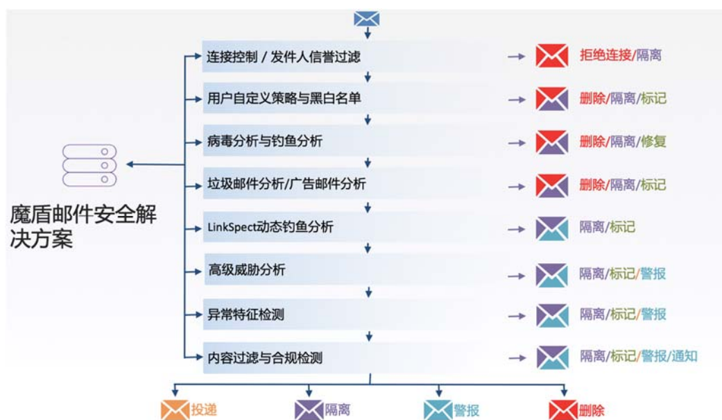
图 4-1 魔盾邮件安全网关分析过程及动作示意图
